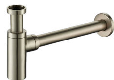
Syfon umywalkowy okrągły, regulowany, przyłącze 1 1/4, odpływ 32 mm, nikiel szczotkowany
