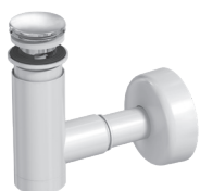
Syfon umywalkowy, czyszczony z góry, gardziel mosiężna, do umywalk z przelewem, odpływ 32/40 mm, korek click-clack, mosiężny, chrom
