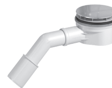
Syfon brodzikowy, otwór odpływowy Ø90mm, wersja niska, rura odpływowa 40/50mm, pokrywka ABS, chrom
