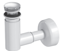
Syfon umywalkowy, czyszczony z góry, do umywalk bez przelewu, odpływ 32/40 mm, mosiężny, chrom
